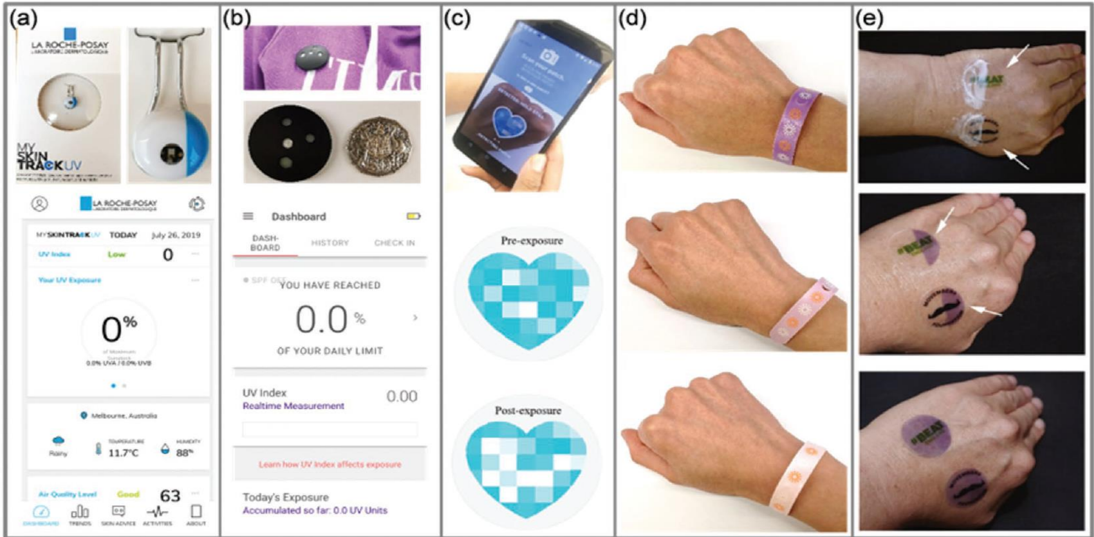
Figura 2. Ejemplos de sensores UV lanzados comercialmente. a) “My skin track UV”. b) “Shade” se usa en la ropa. c) “My UV patch” escaneando el parche usando un teléfono inteligente donde se muestra el parche antes y después de la exposición a los rayos UV. d) “Sundicator” la banda es inicialmente incolora pero se vuelve púrpura después de la activación en el solo por 1 min luego continúa volviéndose púrpura más claro con la exposición de los rayos UV. e) “SPOTMYUV” la etiqueta aparece transparente después de la activación después de la exposición a los rayos UV la etiqueta va cambiando a púrpura.
